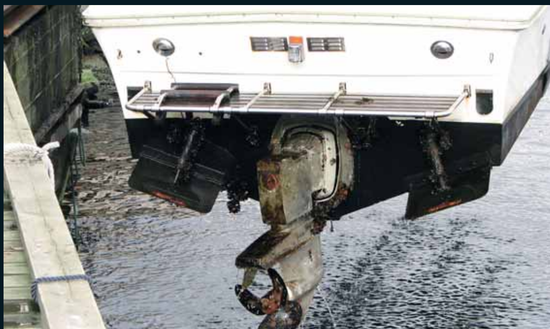
Et typisk groebefengt drev etter en sesong i sjøen. Legg merke til de farlige skjellene som har festet seg i belgsprekken.
