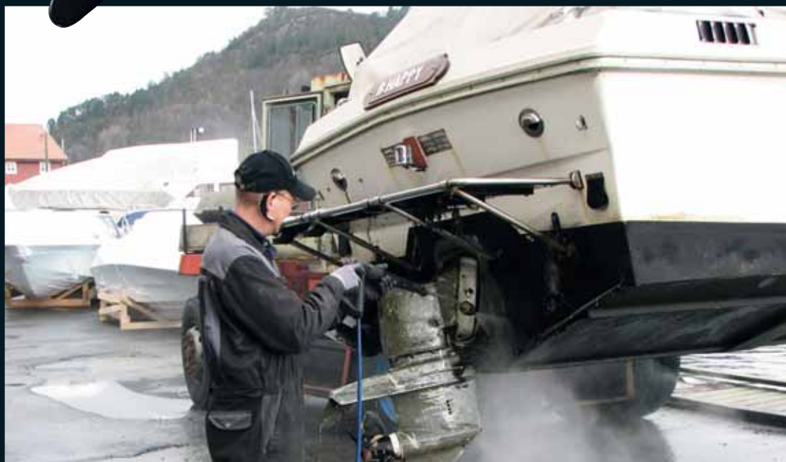
Det krever både tid, flid og forsiktighet å fjerne groe fra drevet med høytrykksspyler.
