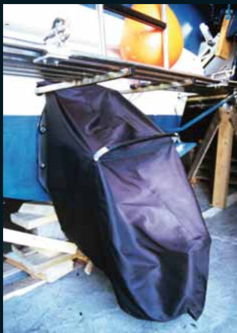
Drevheten dekker hele drevet, belgen og propellen.
